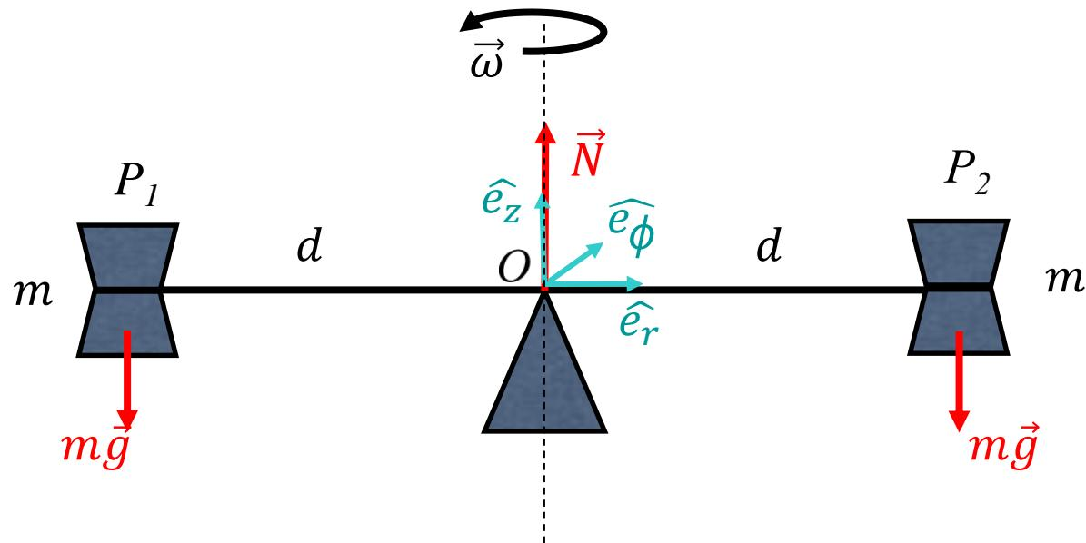
$$\vec{L}_0 = \overrightarrow{OP_1} \wedge m\vec{v}_1 + \overrightarrow{OP_2} \wedge m\vec{v}_2$$
